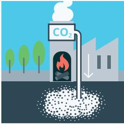
**Principio:** crescendo, le piante catturano il CO<sub>2</sub> dall'atmosfera e lo trasformano in biomassa. Durante la combustione con e senza fiamma o la gassificazione della biomassa, il CO<sub>2</sub> assorbito viene rilasciato. Negli impianti bioenergetici questo CO<sub>2</sub> è catturato direttamente dai gas
