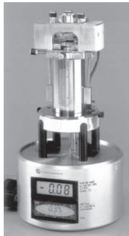
Tête de mesure d'un microscope à force atomique.
